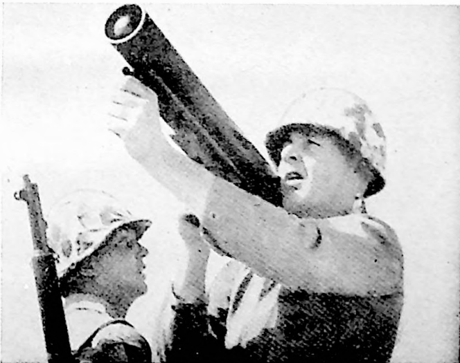
Afb. 19. Releye, een eenmans geleid wapen-systeem, voor de Amerikaanse luchtdoelartillerie, voor de bestrijding van lichte vliegtuigen. Het projectiel heeft een actief doelzoekend systeem. De verpakking is tevens lanceerinrichting.
