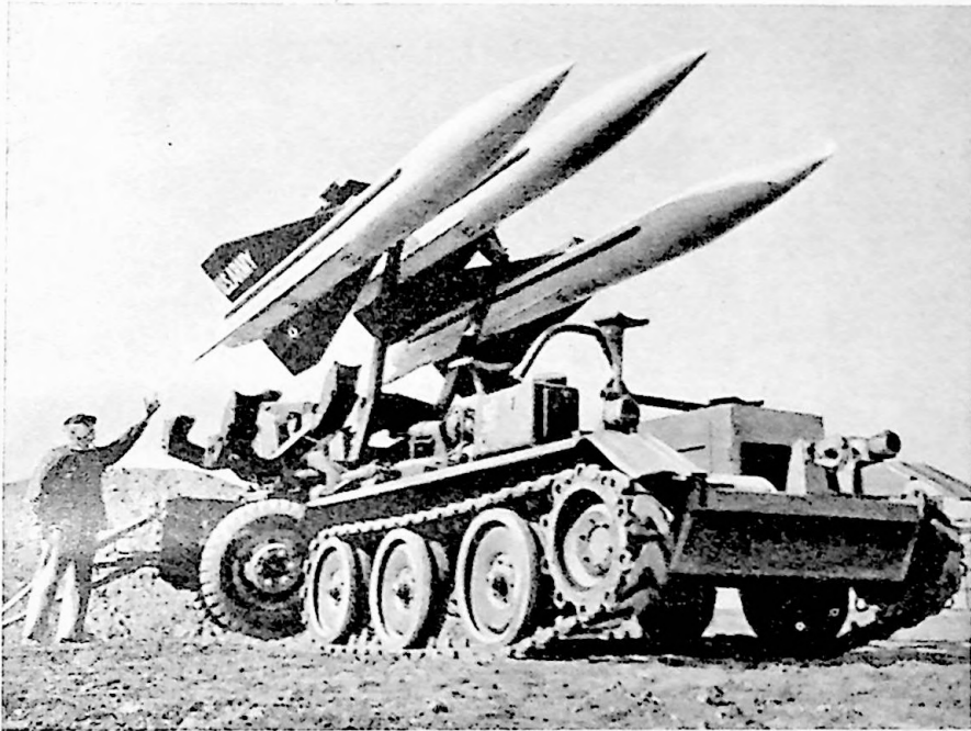
Afb. 16. „Hawk” (Homing All the Way Killer) van de Amerikaanse luchtdoelartillerie, hoogtebereik \pm 15 km, max. schootsafstand \pm 30 km. Ook in de Russische legers is een dergelijk wapen met 40 km dracht in grote aantallen beschikbaar.
