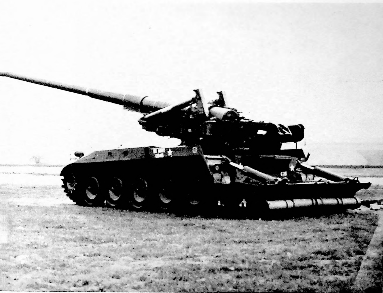
DE TOEKOMSTIGE NEDERLANDSE ZWARE ARTILLERIE: het 175 mm kanon op rupsvoertuig, dracht 32 km. Bestemd voor het parate Legerkorps.
