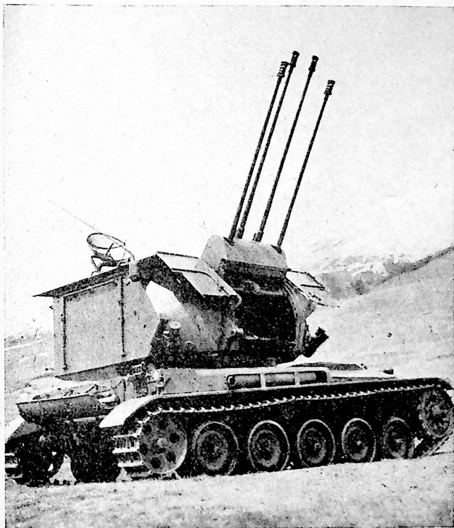
Afb. 11. Flak-Panzer 12 PFV van Oerlikon, 20 mm kaliber, radargestuurd, 4000 schoten/min.
