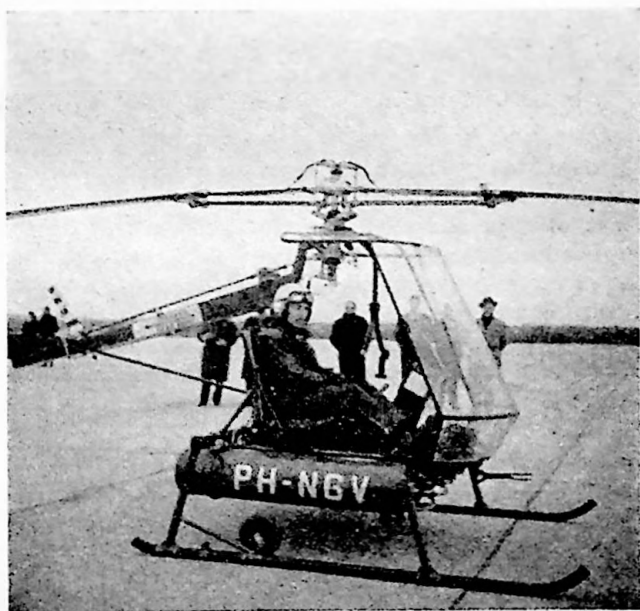
„Kolibri“ — lichte ramjet-helikopter.
