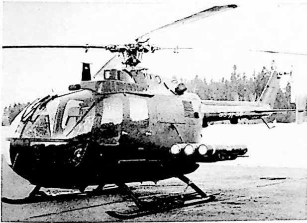
Neue Aufgabe für Heeresflieger: der Panzerabwehrhubschrauber (PAH) Bo-105M-PAH mit Euromissile Lenkflugkörper Hot
